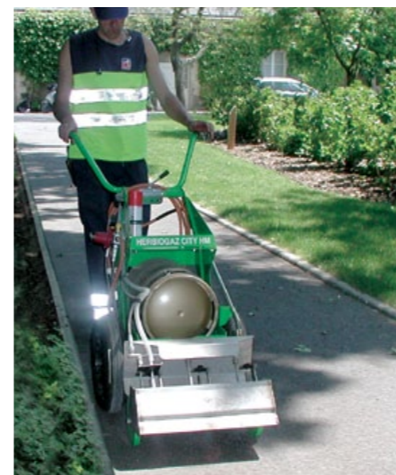
Désherbeur HERBIOGAZ CITY 3B HM Rampe 3 brûleurs + lance "Homme Mort"
