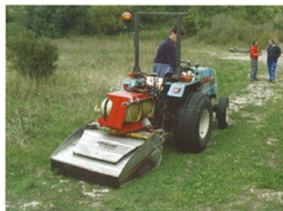
L'Herbiogaz Country se monte à l'arrière d'un tracteur et travaille sur une largeur de 1 m.
