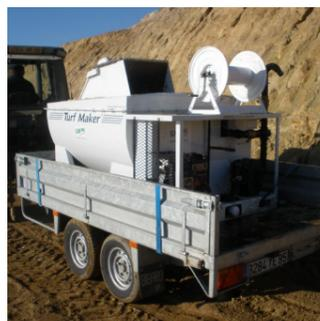
L'hydroseeding est une technique par projection hydraulique destinée à la réalisation d'engazonnement où les interventions avec des méthodes traditionnelles ne sont pas envisageables.
