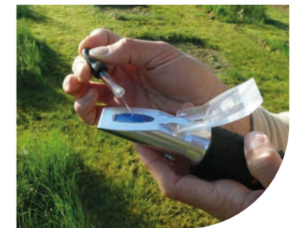
Lecture sur le prisme d'un réfractomètre optique
